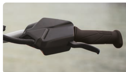
Système de freinage et marche arrière intelligents iBR® Exclusivité Sea-Doo®, l'iBR stoppe la motomarine plus tôt et offre davantage de confort et de manoeuvrabilité à vitesse basse et en marche arrière.
